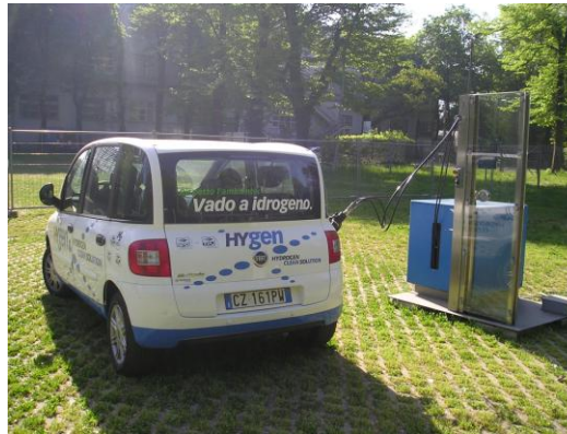
Progetto MRI: stazione di rifornimento di H 2 compresso (200 bar)
